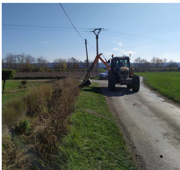
Faucardage hivernal mécanique des filioles et réseaux secondaires (ent. GERVASONI)
