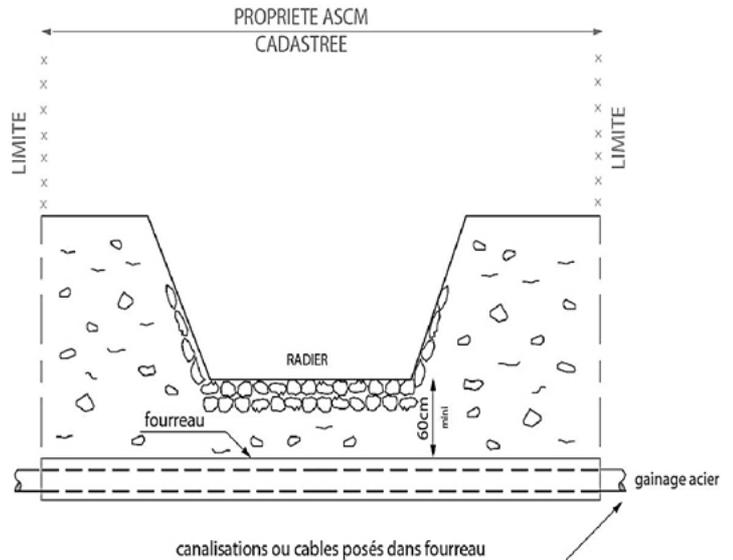
La canalisation ou le câble sont placés dans un fourreau et enfouis à une profondeur de 60 cm sous le radier de la filiole. Une fois la tranchée effectuée, le radier doit être recaladé et/ou bétonné, en respectant le fil d'eau.
